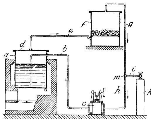
unter Erhitzung in einem geschlossenen Gefäß, z. B. im Autoklaven, mit im Kreislauf bewegtem, gasförmigem Ammoniak behandelt werden, wobei das von dem überschüssigem Ammoniak aus dem Autoklaven mitgerissene Reaktionswasser in einer Trockenvorrichtung abgeschieden, und das wasserfreie Ammoniak mittelbar oder unmittelbar wieder in den Autoklaven zurückgeführt wird.
