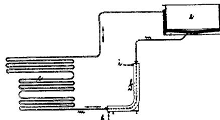
endlosen Heizschlangen die erforderliche Geschwindigkeit des kreisenden überhitzten Wassers zu erzielen. —
